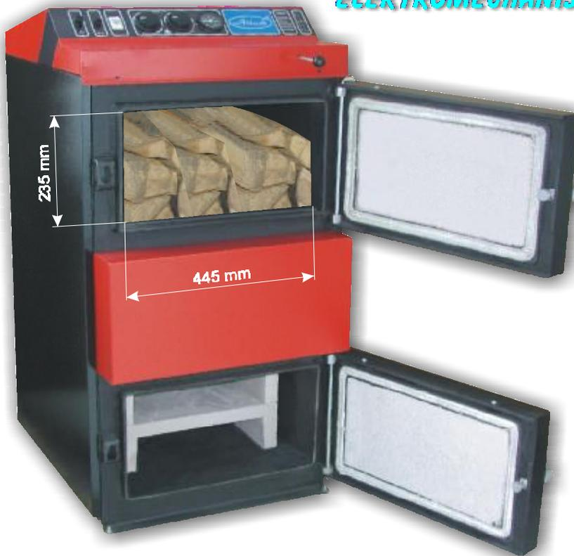
Die Leistungsregulierung wird mit der Zuklappe in hinterer Kesselseite geleistet, die durch Kesselregulator gesteuert wird. Dieser macht die Zuklappe nach der eingestellten Ausstiegswassertemperatur ( 80-90 °C) automatisch auf oder zu. Der Regulatoreinstellung ist höhere Aufmerksamkeit zu widmen, wiefern er außer Leistungsregulierung auch weitere wichtige Funktion leistet, er sichert den Kessel vor Überhitzung.
